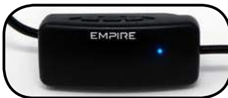
Led di funzionamento e Display "upside down" per una facile lettura
